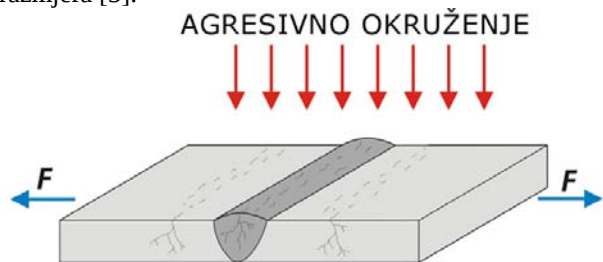
Slika 3. Čimbenici koji utječu na pojavu napetosne korozije [6]
