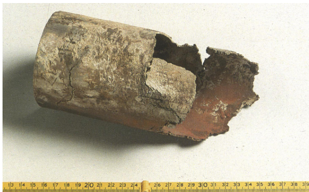
Slika 17. Kloridna napetosna korozija AISI 316 čelika – transkristalan lom [5]
