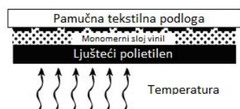
Slika 14. Presjek transferne folije pogodne za prihvaćanje tinta bojila na bazi organskih otapala [11]
