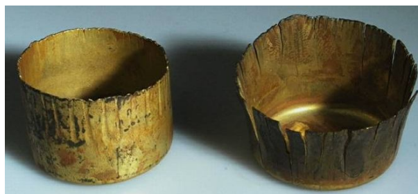
Slika 13. Napetosna korozija čahura streljiva nastala u agresivnom okruženju amonijaka [12]
