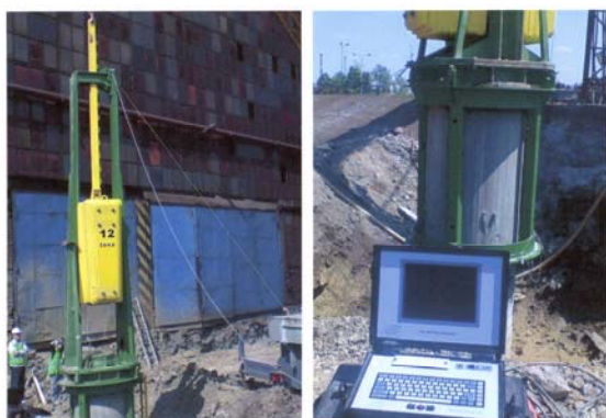
Slika 6. Oprema za dinamičko ispitivanje pilota
