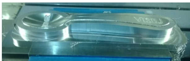
Slika 16. Prikaz gotove operacije 3D glodanja konture žiga
