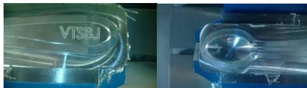
Slika 15. Prikaz gotove operacije 3D graviranja žiga
